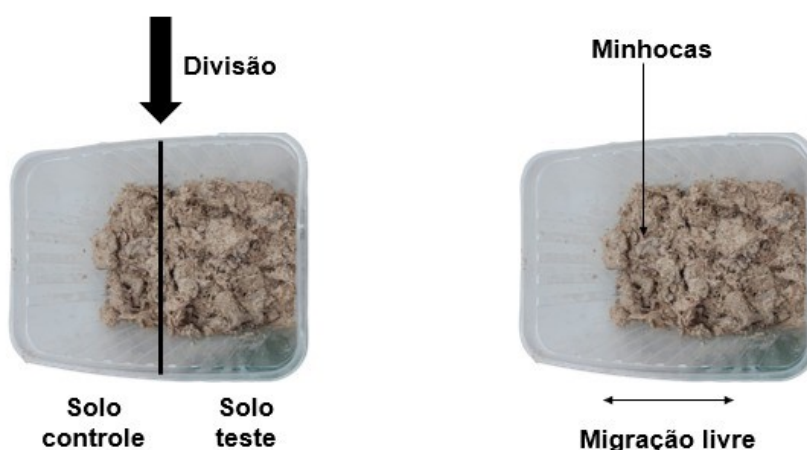
Figura 4 - Esquema do ensaio de fuga com minhocas da espécie Eisenia fetida
