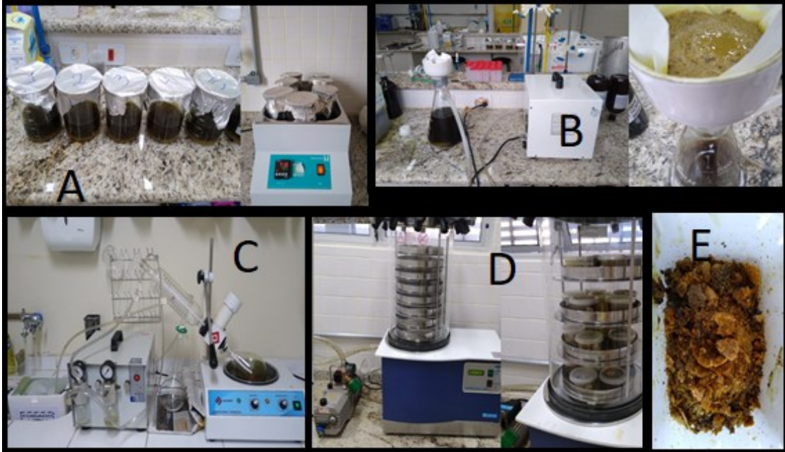
Fotografia 2- Processo de extração da própolis verde. A- diluição, B- filtração, C- rotoevaporação, D- liofilização e E- produto final da própolis verde.
