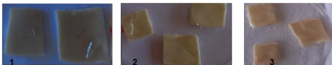
Figura 17 – Modificações constatadas no teste de aplicabilidade de um filme não biodegradável
