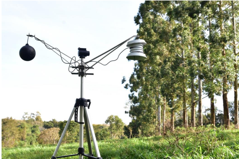
Figura 5: Alocação do tripé com data logger e globo negro no sistema silvipastoril.
