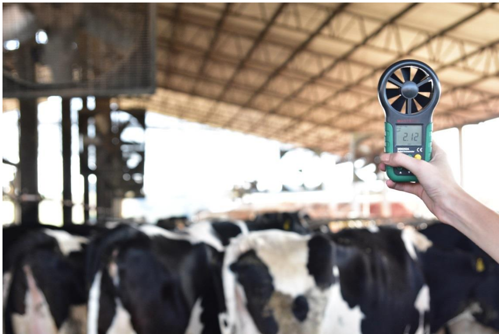
Figura 8: Mensuração da velocidade do vento no sistema free stall .
