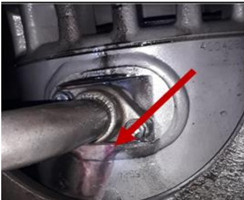
Figura 26 - Dreno de retorno obstruído locomotiva 3812
