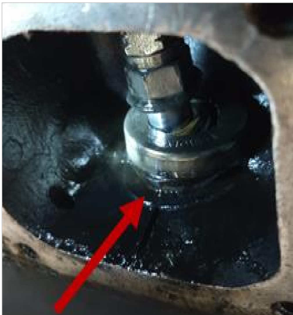
Figura 25 - Dreno de retorno obstruído locomotiva 3812
