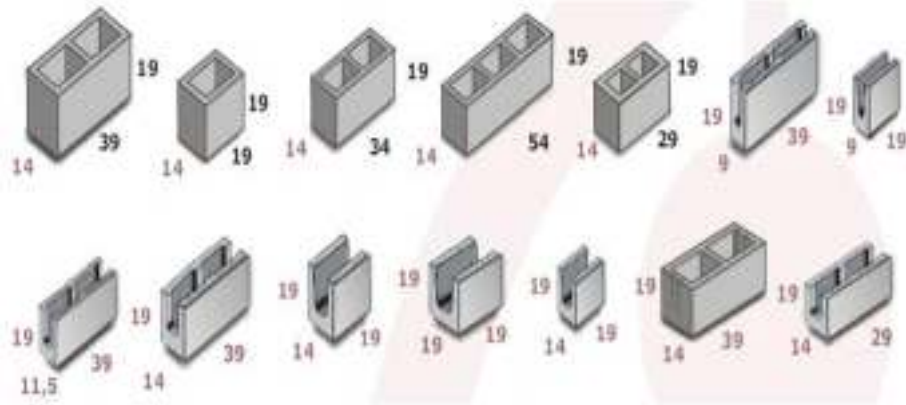
Figura 3 - Tipos de bloco de concreto vazado Fonte: Mohamad (2015).
