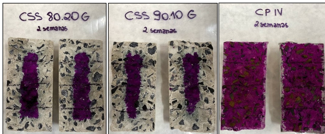
Figura 33 - Amostras de concreto com aplicação de fenolftaleína após 2 semanas de exposição à carbonatação acelerada. Fonte: Autor.
