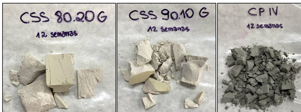
Figura 40 - Amostras de pasta com aplicação de fenolftaleína após 12 semanas de exposição à carbonatação acelerada.
