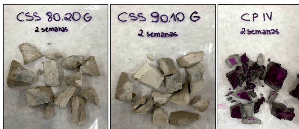
Figura 34 - Amostras de pasta com aplicação de fenolftaleína após 2 semanas de exposição à carbonatação acelerada. Fonte: Autor.
