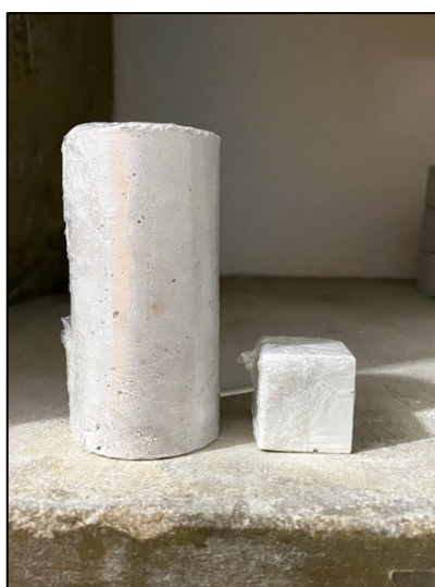
Figura 30 – Amostras de concreto e pasta envoltas em plástico filme na etapa de pré-condicionamento. Fonte: Autoria Própria
