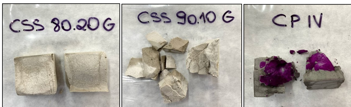
Figura 36 - Amostras de pasta com aplicação de fenolftaleína após 4 semanas de exposição à carbonatação acelerada.
