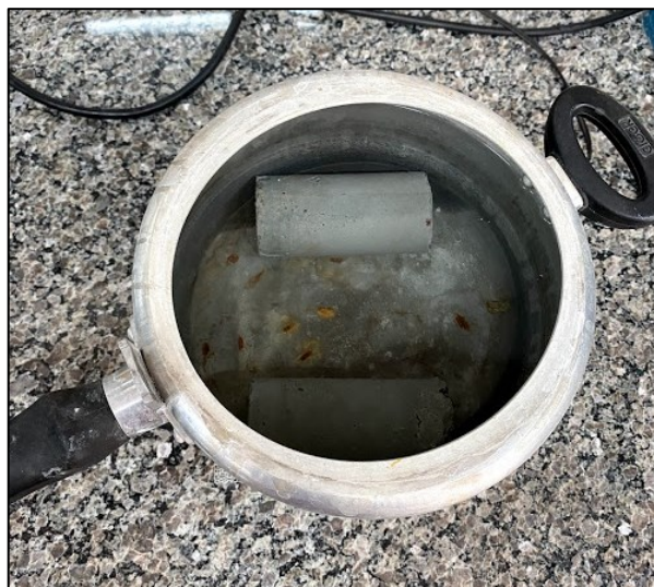
Figura 28 - Amostras no processo de ensaio de índice de vazios. Fonte: Autoria Própria
