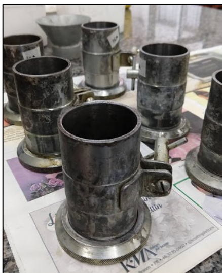
Figura 26 - Moldes metálicos nos formatos de 5x10 cm. Fonte: Aatoria Própria.
