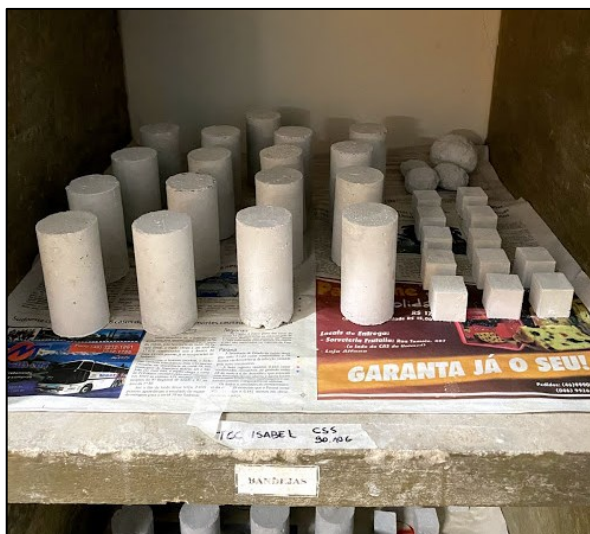
Figura 29 - Amostras de CSS na câmara climatizada após o período de cura úmida. Fonte: Autoria Própria
