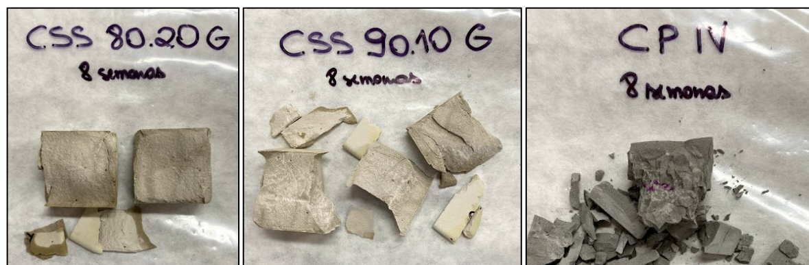
Figura 38 - Amostras de pasta com aplicação de fenolftaleína após 8 semanas de exposição à carbonatação acelerada.
