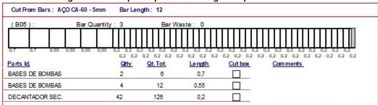
Figura 22 - Exemplo de plano de corte gerado para barra de 5 mm
