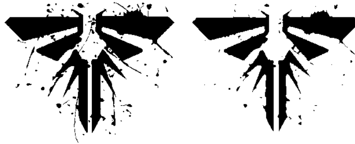
Figura 12 – Operação de Erosão sobre uma imagem binária (a) Original (b) Erodida
