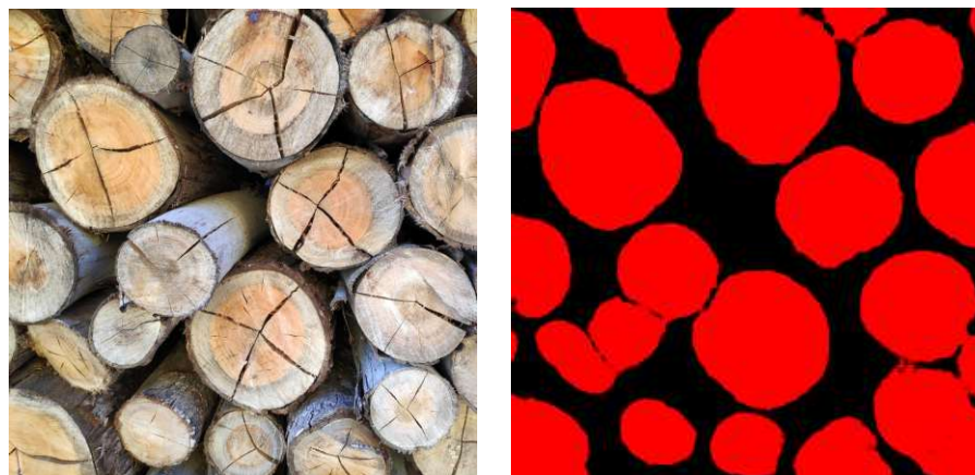
Figura 31 – Demonstração da segmentação gerada pelo modelo (a) Imagem de entrada (b) Segmentação gerada pelo modelo
