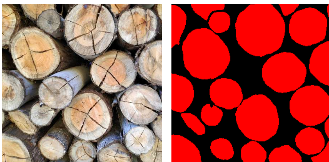
Figura 24 – Demonstração da segmentação manual aplicada (a) Imagem original (b) Segmentação Ground Truth
