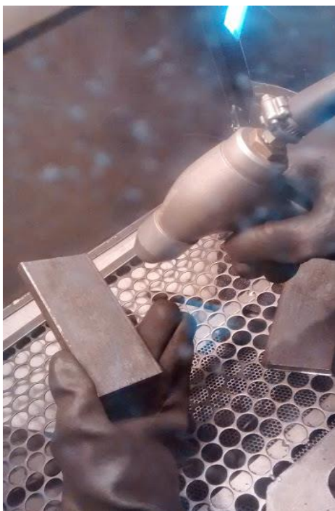
Figura 14: Jateamento por granalha.
