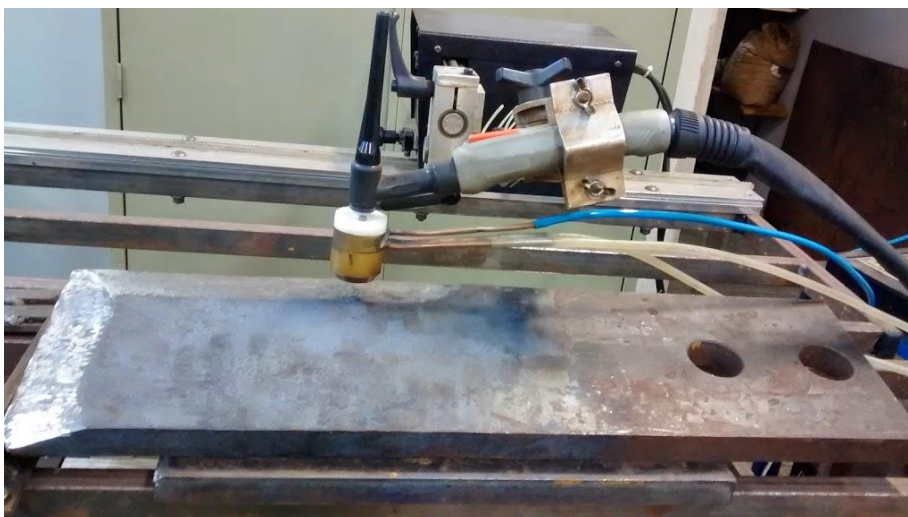
Figura 11: Substrato preparado para receber o revestimento.
