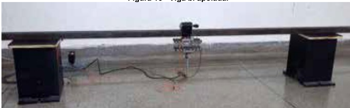
Figura 16 - Viga bi apoiada.
