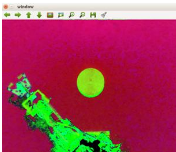
Figura 30 - Representação HSV de uma imagem da câmera com o objeto no centro
