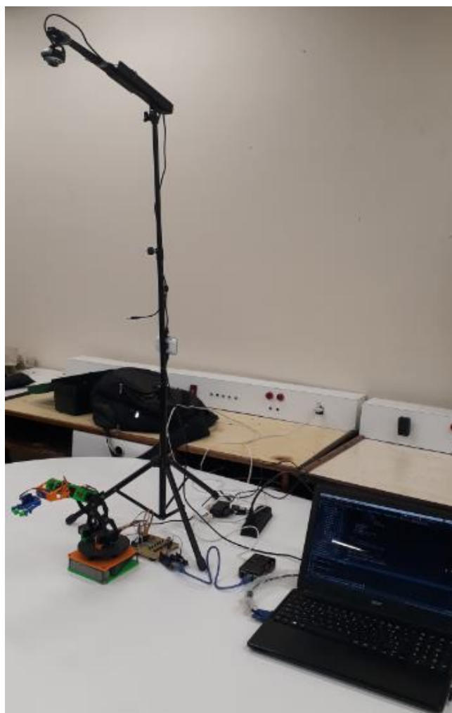
Figura 42 - Posicionamento da webcam para detecção de obstáculos.
