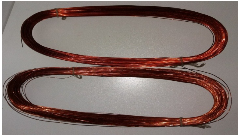
Figura 14 – Fios esmaltados AWG20 e AWG23. Fonte: (Autoria própria).
