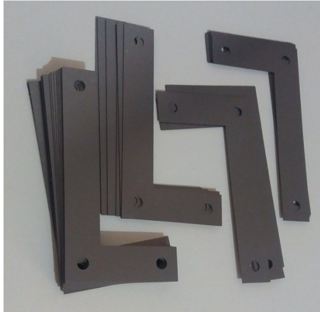
Figura 2 – Lâminas de aço silício. Fonte: (Autoria própria).
