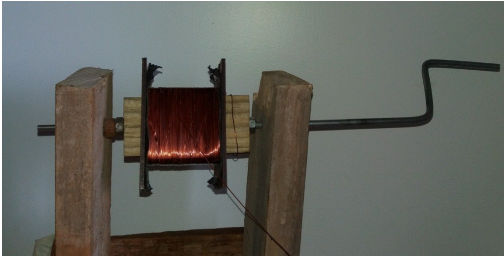
Figura 13 – Dispositivo para enrolar bobinas. Fonte: (Autoria própria).
