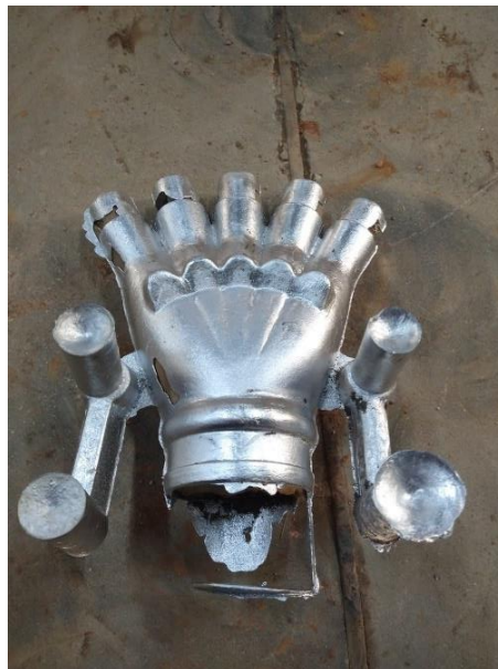
Figura 6: Peça após o desmolde.
