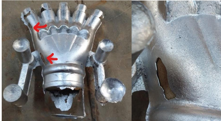
Figura 18: Peça Rejeitada do Tipo A devido a Falha.
