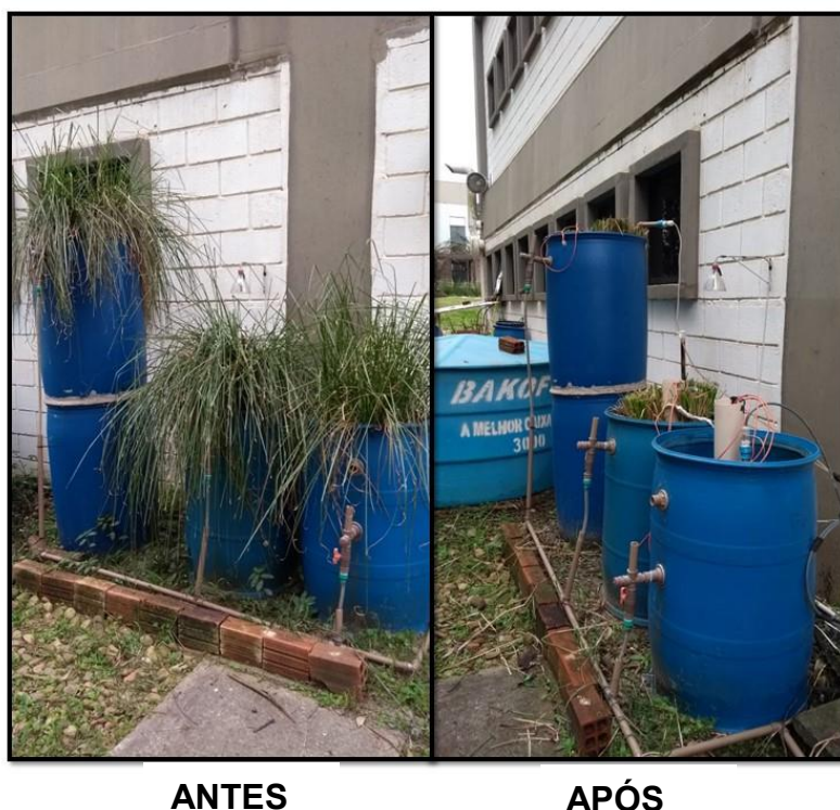
Figura 10 - Imagens do antes e após do corte das macrófitas no 471º dia de operação
