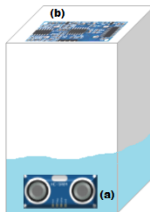
Figura 5 - Localização dos Sensores no Dispenser
