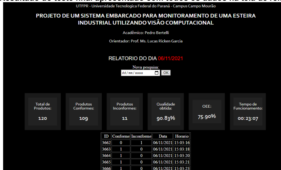
Figura 22 - Resultado do teste final apresentado com todos os dados na tela de relatório
