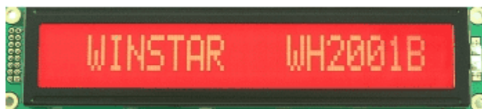
Figura 4 - Display LCD 20x1
