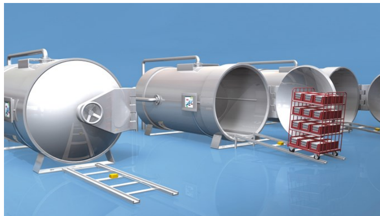
Figura 16 - Fornos de vulcanização em layout proposto pela empresa
