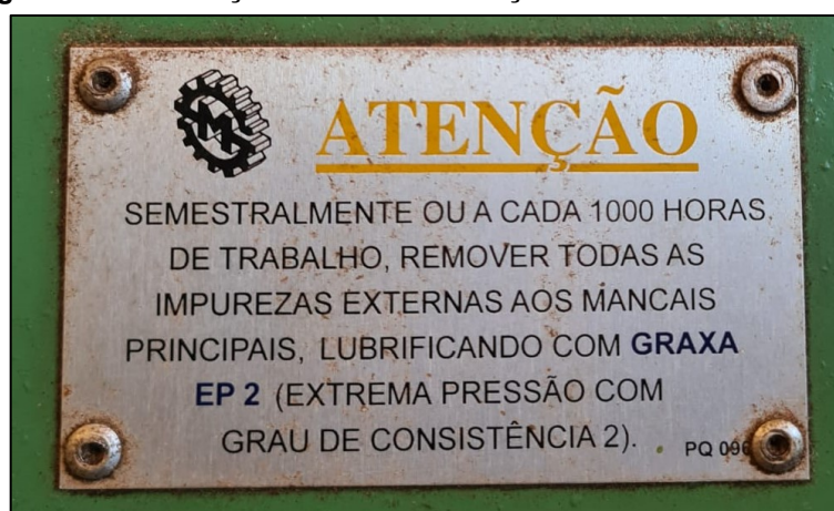
Figura 09: Informações sobre lubrificação da Serra Fita Tanden.
