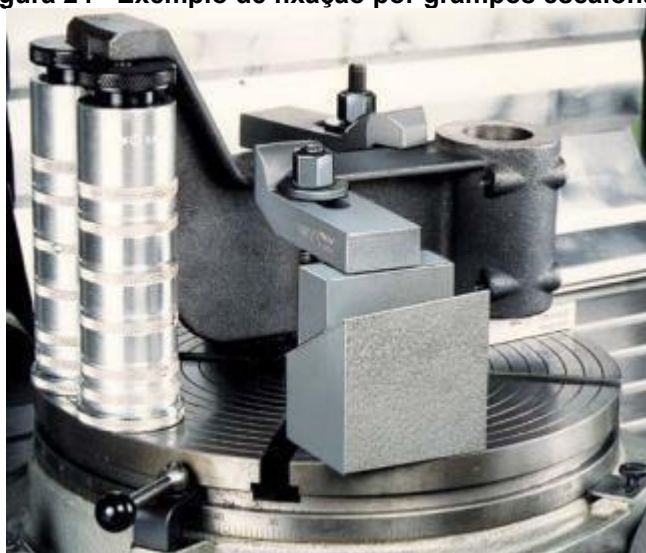
Figura 24 - Exemplo de fixação por grampos escalonado
