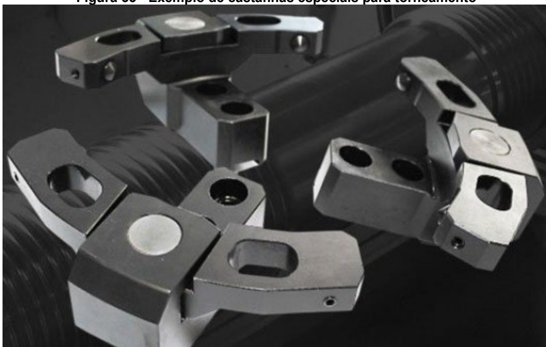
Figura 53 - Exemplo de castanhas especiais para torneamento
