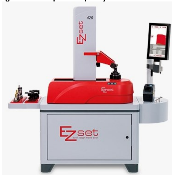
Figura 31 - Máquina de pré-ajuste de ferramentas
