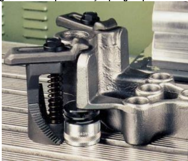
Figura 23 - Exemplo de fixação por grampos escalonado
