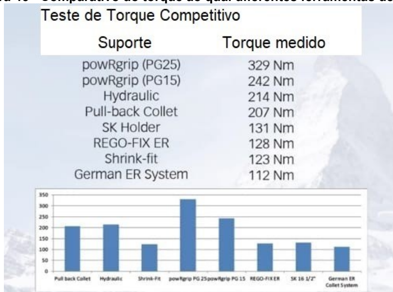
Figura 46 - Comparativo do torque ao qual diferentes ferramentas deslizam
