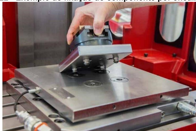
Figura 22 - Exemplo de fixação do componente por encaixe rápido
