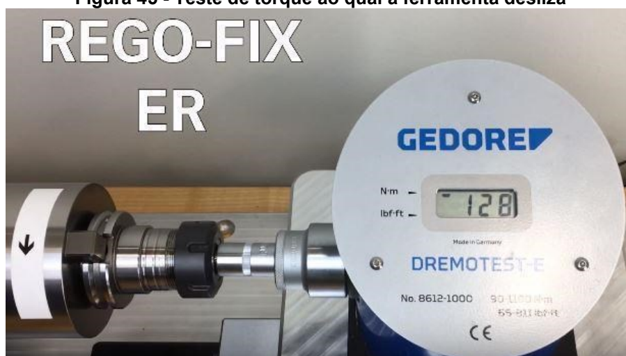
Figura 45 - Teste de torque ao qual a ferramenta desliza
