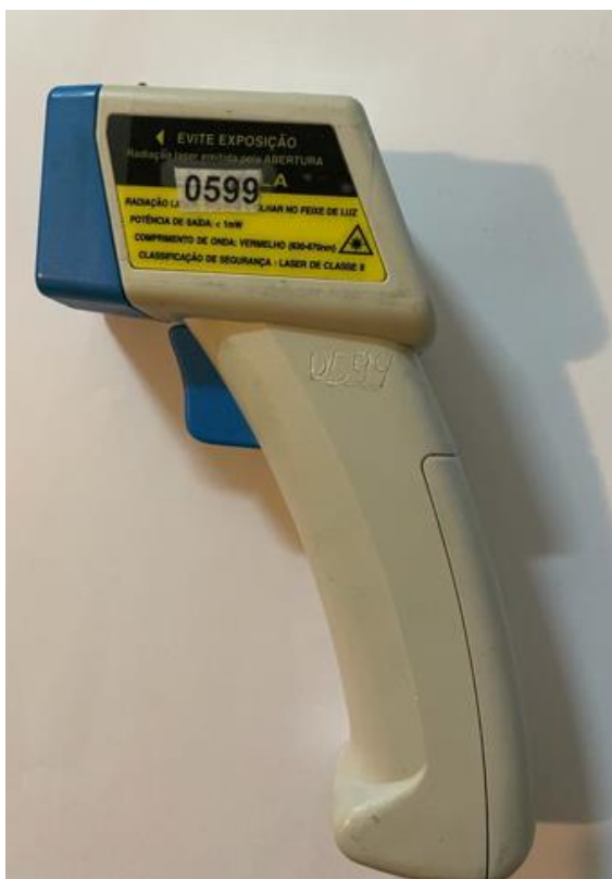
Figura 7 – Termômetro digital do tipo laser utilizado para aferir a temperatura do cilindro, banheira e ambiente.
