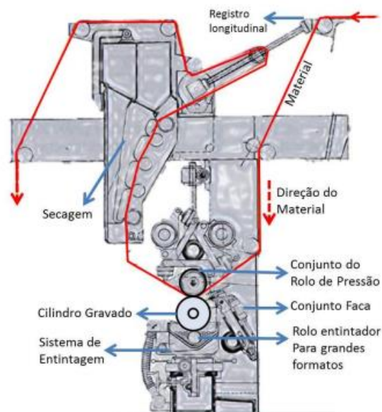
Figura 4 – Exemplificação do processo de impressão rotográfica.
