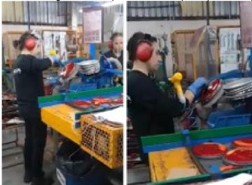
Figura 26 – Montagem dos componentes da tampa da placa de pressão
