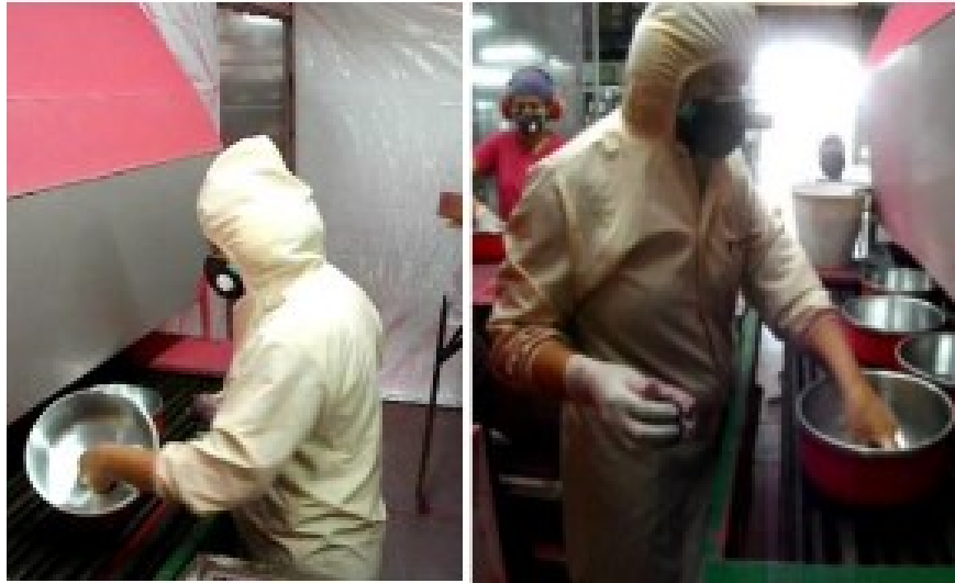
Figura 16 - Operador no preparo das peças para a estufa de cura de tinta
