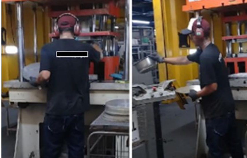
Figura 8 – Prensagem hidráulica dos disco de alumínio
