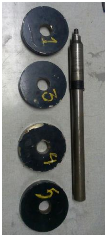
FIGURA 15 – HASTE E PESOS UTILIZADOS NO ENSAIO DE RISCAMENTO.
