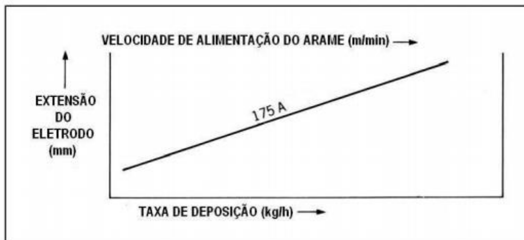
Figura 18 - Efeito da extensão do eletrodo na taxa de deposição
