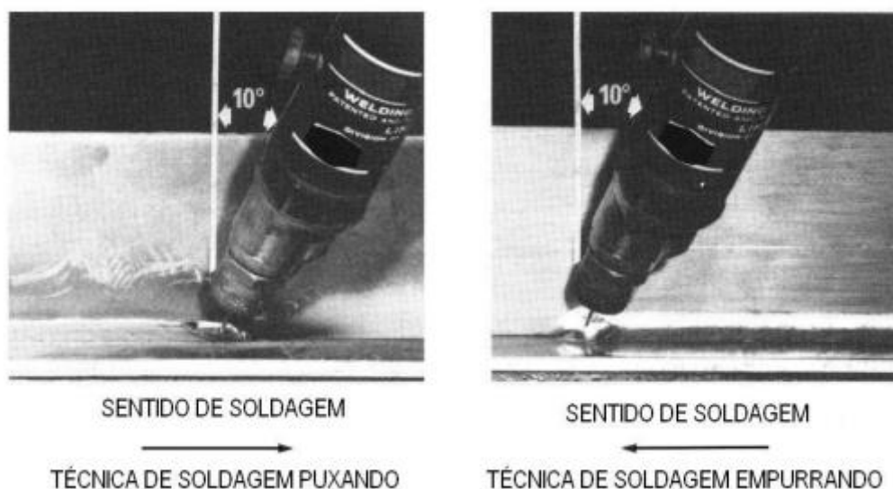
Figura 13 - Soldagem puxando e empurrando
