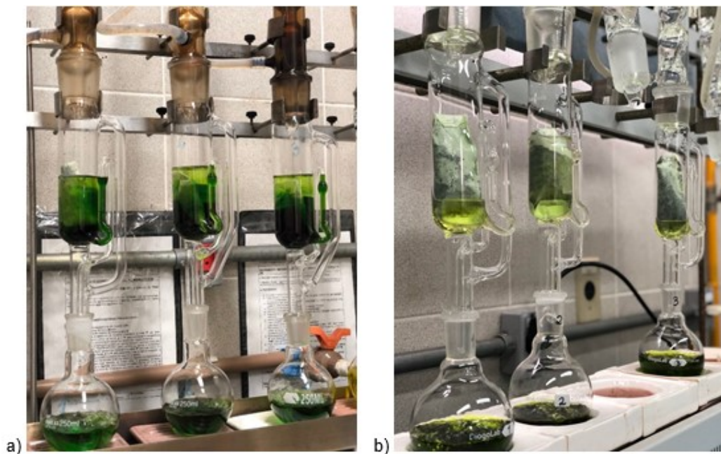
Figura 22 – Processo de Soxhlet a) com etanol e b) com hexano
