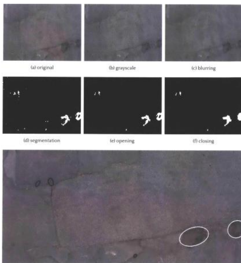
Figura 32: Resultado da metodologia e saída do algoritmo de Petkova para identificação de defeitos do tipo Panelas Fonte: Petkova (2016)
