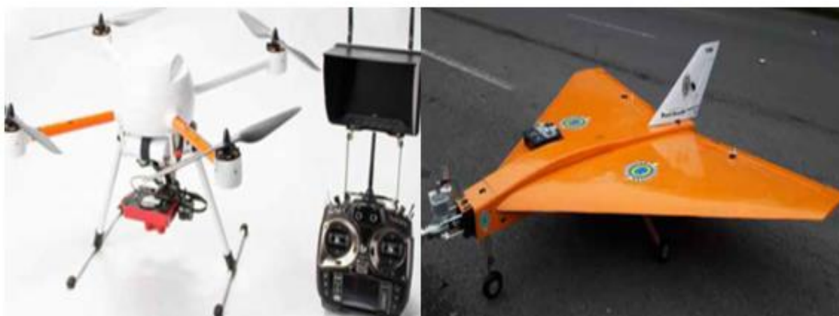
Figura 28: VANTs de asa rotativa (esquerda) e asa fixa (direita) Fonte: Pecharromán (2010)
