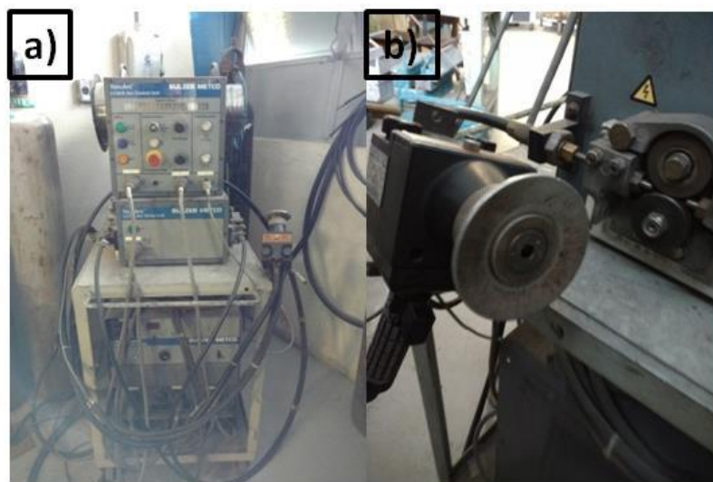
Figura 9 – Equipamento de aspersão térmica a arco elétrico.
