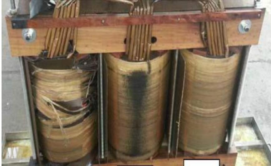
**Figura 5 – Curto-circuito causado por dano ao isolamento**
