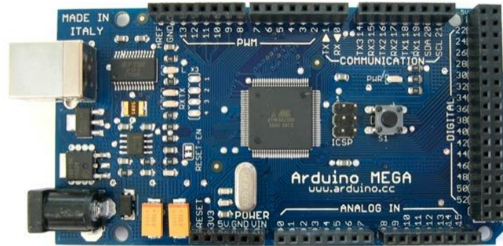
Figura 3 - Plataforma Arduino Mega Fonte: < http://arduino.cc/ >, 2013
