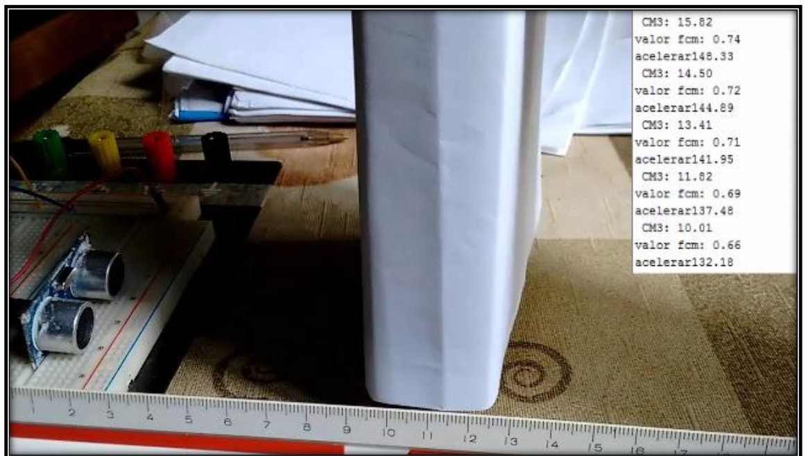
Figura 22. Demonstração teste de distancia e atuação do FCM.
