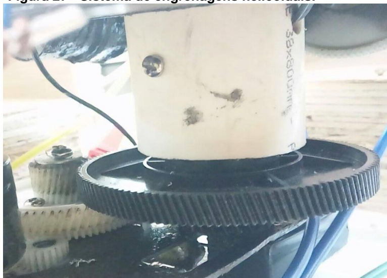
Figura 27 - Sistema de engrenagens helicoidais.
