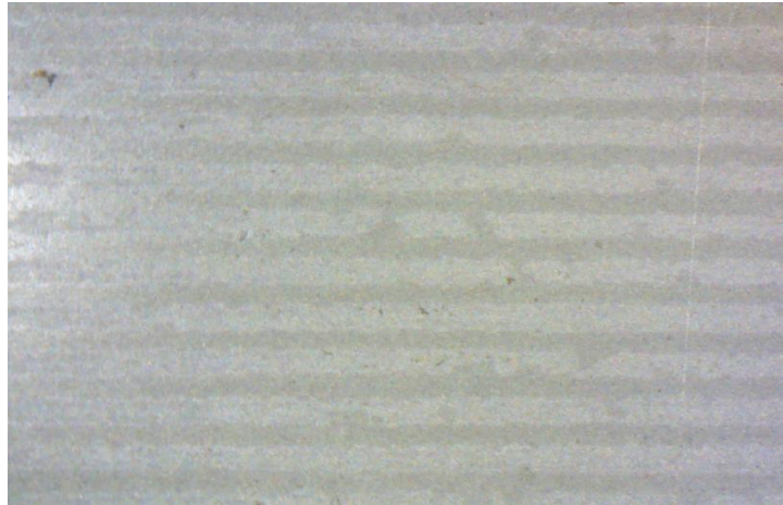
Figura 3 - Micrografia de uma chapa de FeSi com GO
