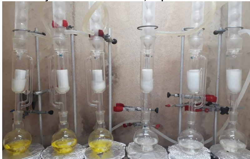
Fotografia 3 - Extração contínua de extrato etéreo em aparato soxhlet de amostras de Stachys byzantina seca e in natura, respectivamente
