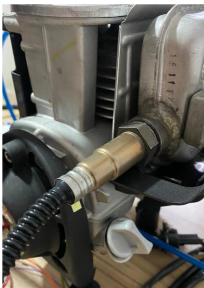
Figura 48 - Sonda Lambda adaptada ao motor Fonte: Própria Autor
