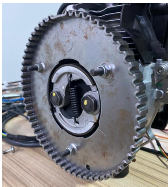
Figura 46 - Roda fônica instalada Fonte: Próprio Autor
