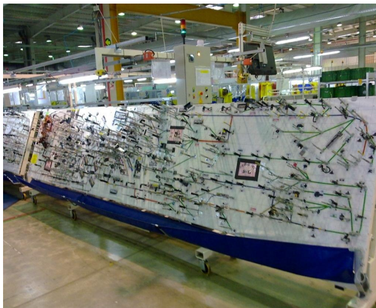
Figura 17 - Montagem chicote elétrico Fonte: Jost; Doyon (2019)
