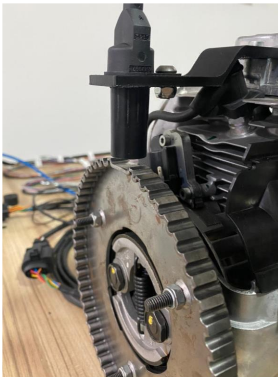
Figura 47 - Sensor de rotação instalado Fonte: Próprio Autor
