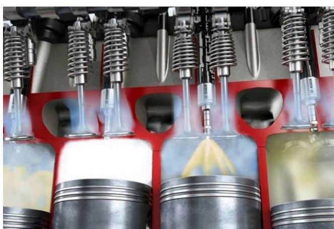
Figura 20 - Injeção direta de combustível Fonte: Silva (2020)
