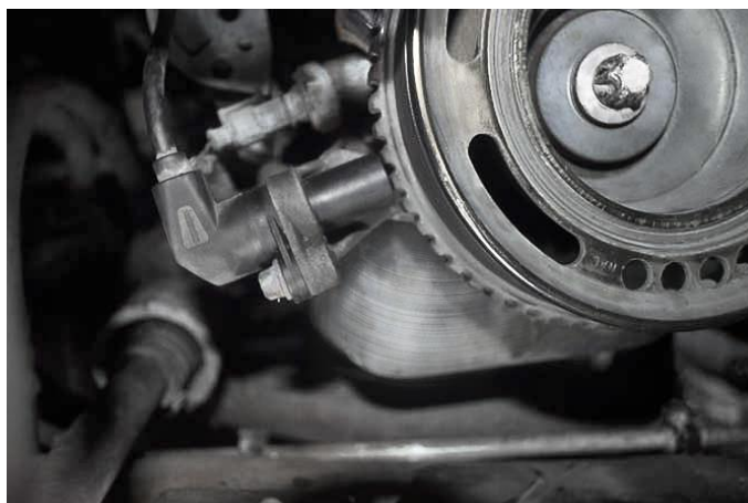
Figura 27 - Roda fônica e sensor de rotação Fonte: Doutor-IE (2013)
