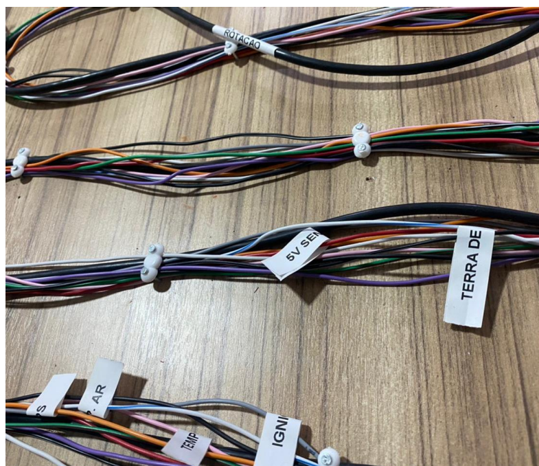
Figura 37 - Identificação dos cabos Fonte: Próprio Autor
