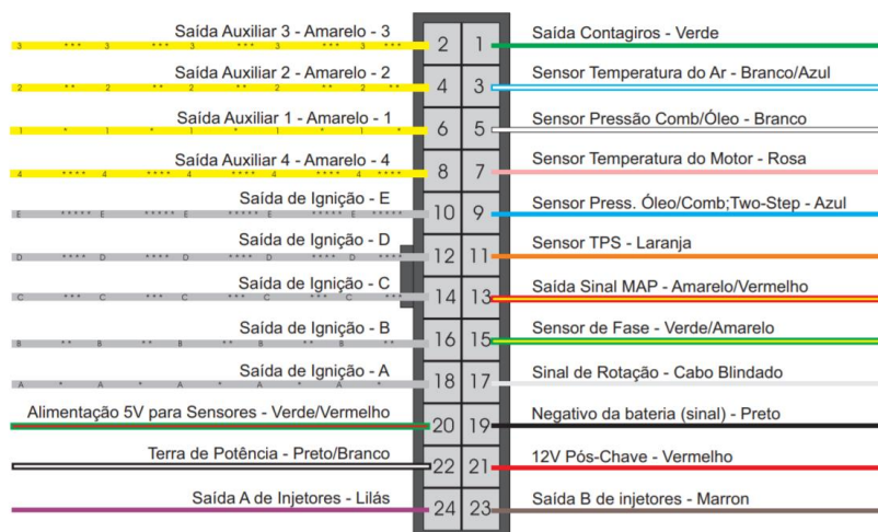
Figura 34 - Pinos de ligação Fueltech FT300 Fonte: Fueltech (2021)
