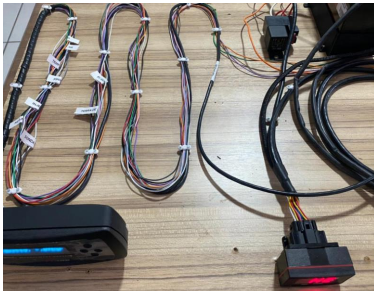
Figura 36 - Chicote elétrico organizado e identificado Fonte: Próprio Autor
