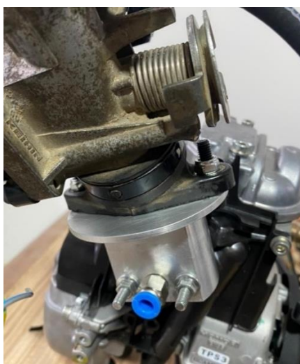
Figura 44 - Adaptador TBI instalado Fonte: Próprio Autor
