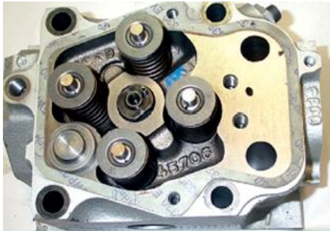
Figura 9 - Válvulas de admissão e escape no cabeçote Fonte: Mercedes Benz do Brasil (2006)
