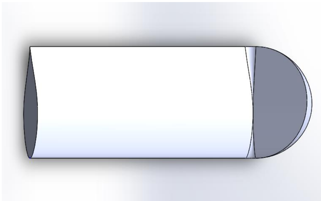
Figura 8 – Construção da asa com perfil NACA65 3 -218 e Winglet 2 (Krishnan et al., 2020).
