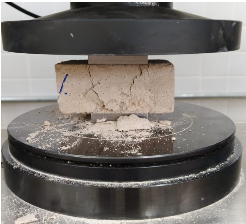
Fotografia 11 - Ensaio de resistência à compressão A50
