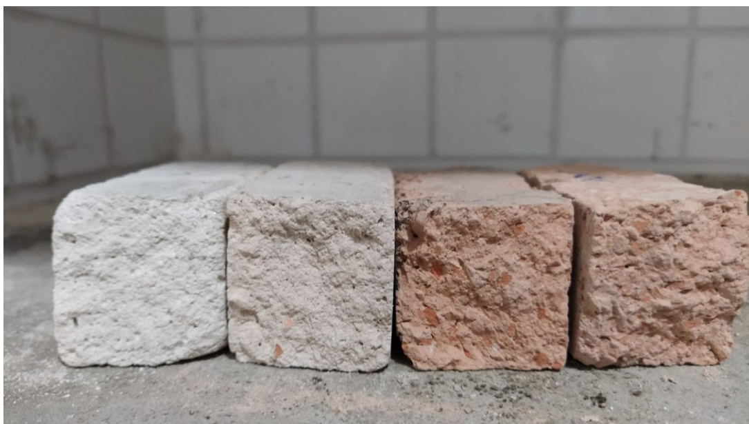
Fotografia 9 - Corpos de prova após o ensaio de resistência à tração na flexão
