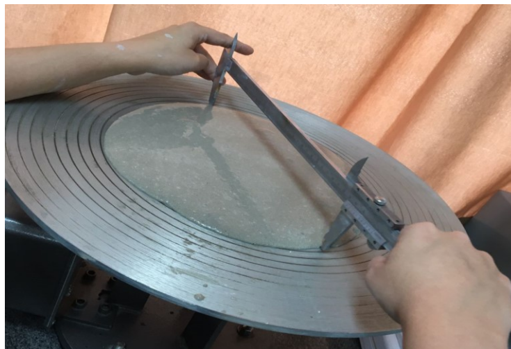
Fotografia 5 - Espalhamento da argamassa
