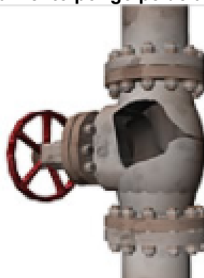
Figura 8- Rompimento por golpe de aríete em conexão
