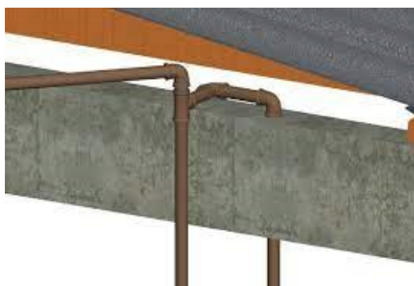
Figura 7- Falha na fase de projeto: incompatibilização de sistemas
