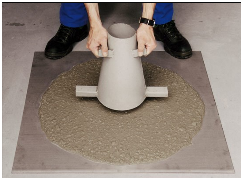
Figura 12- Slump Flow Test, concreto auto adensável
