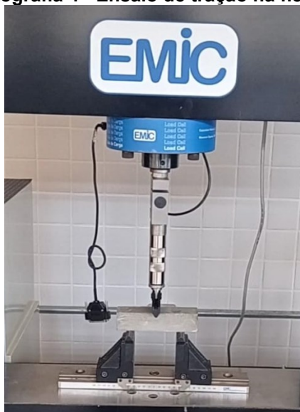
Fotografia 4 - Ensaio de tração na flexão.
