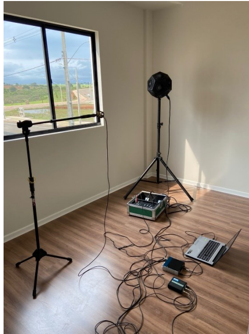
Figura 20 - Posições dos equipamentos de medição no cômodo analisado.
