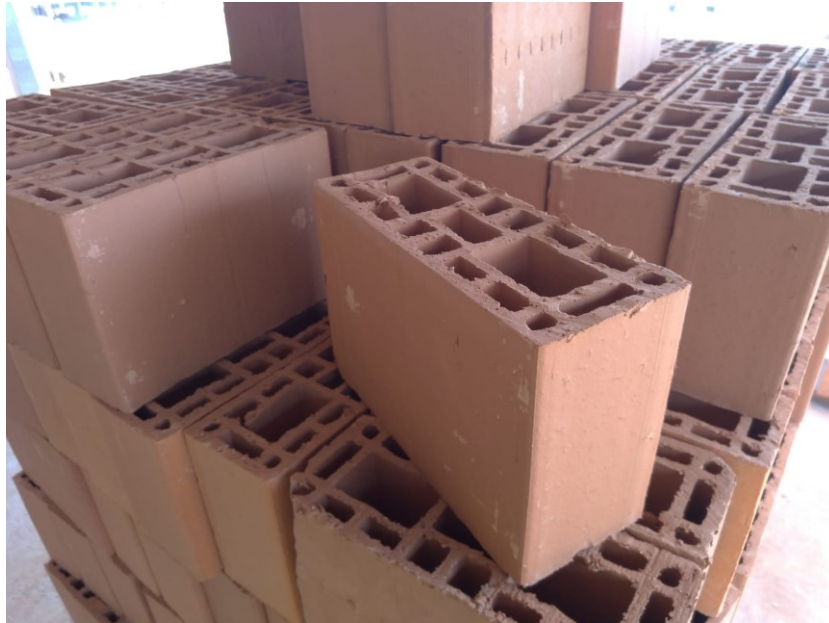
Figura 12 - Bloco cerâmico vazado comum utilizado para vedação da fachada.
