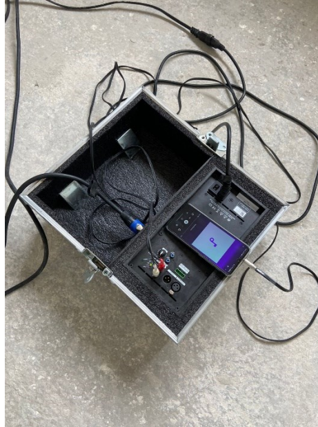
Figura 10 - Equipamento utilizado para emissão de ruído rosa.
