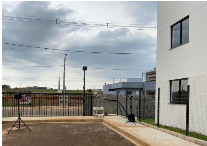
Figura 16 - Posição do amplificador em relação a fachada.
