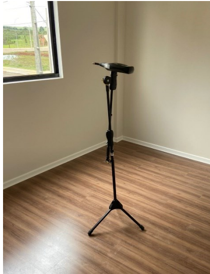
Figura 17 - Microfone dentro do cômodo analisado.
