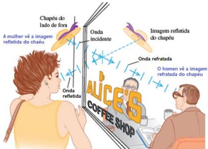
Figura 2: Ondas refletidas e refratadas em uma janela.
