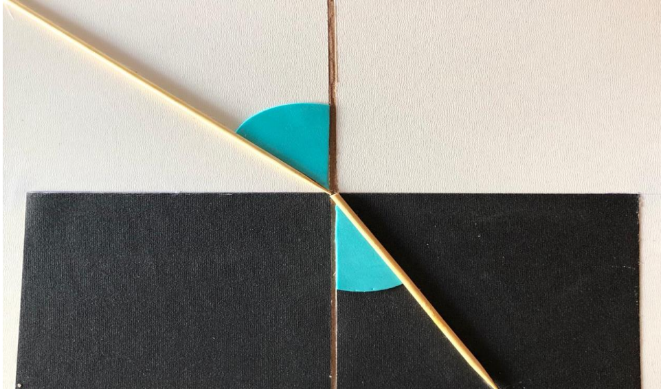
Figura 13: Refração na interface ar-vidro ( 45^\circ - 28^\circ )
