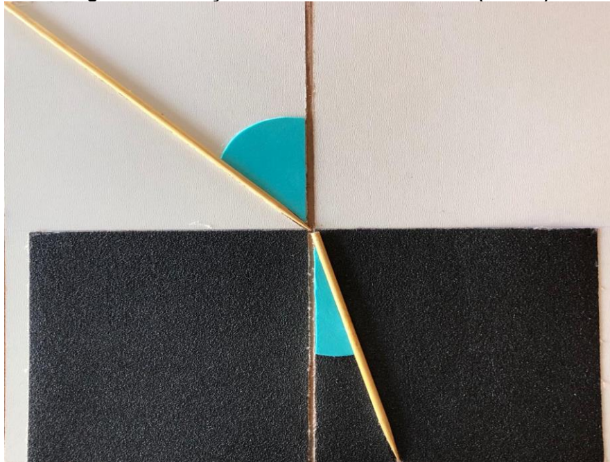
Figura 14: Refração na interface ar - diamante ( 45^{\circ} - 17^{\circ} )
