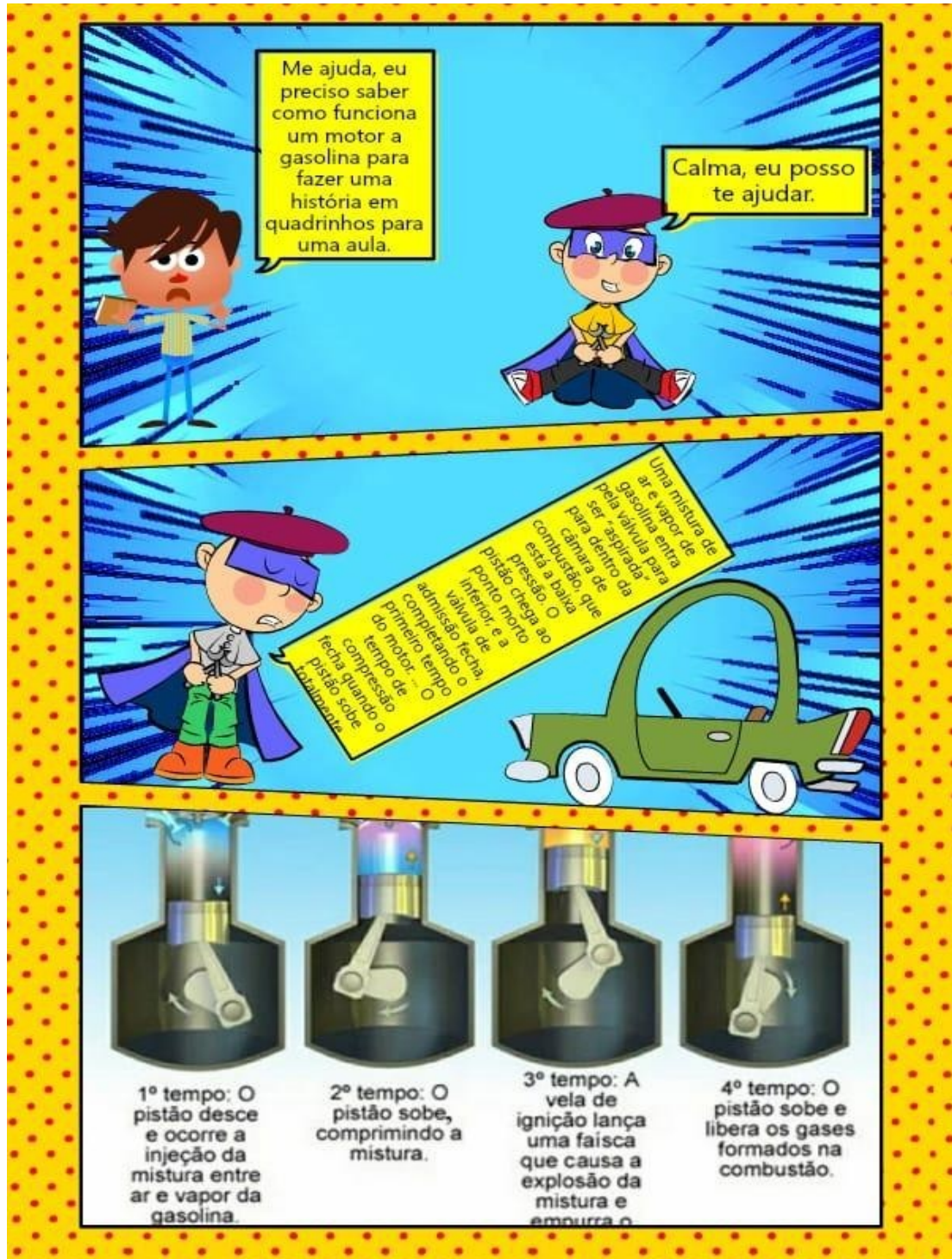
Figura 14 - História em quadrinhos sobre o funcionamento de um motor à gasolina
