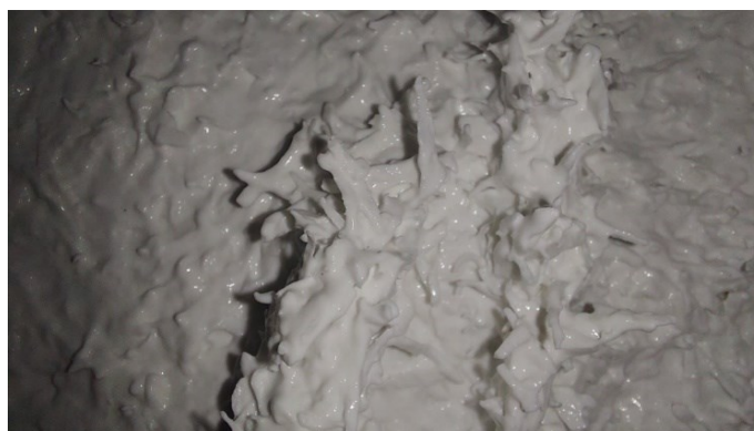
Imagem 5 - Massa acrílica texturizada antes da aplicação.
