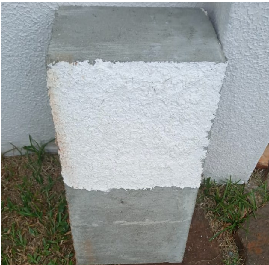
Imagem 11 – Resultado do teste de resistência a intempéries para a massa acrílica texturizada.
