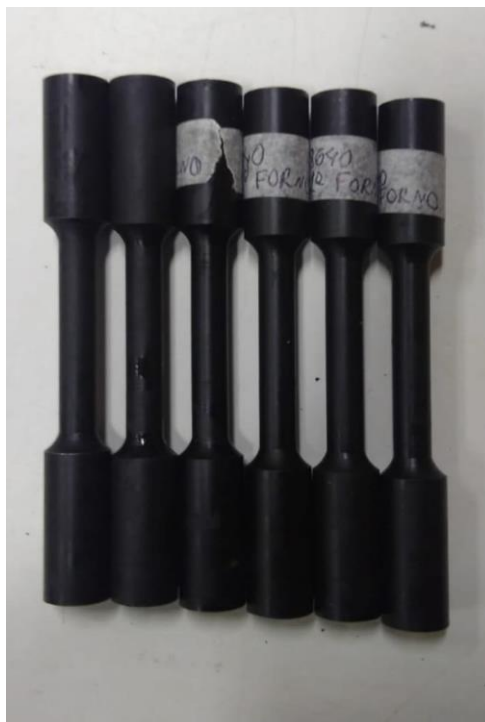
Figura 26 - Corpos de prova após os tratamentos térmicos.
