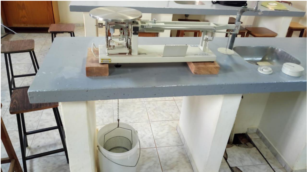
Figura 5: Bancada com balança hidrostática utilizada nos ensaios de absorção de água dos corpos de prova.
