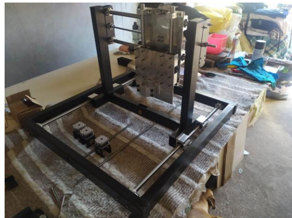
(b) Montagem da estrutura
