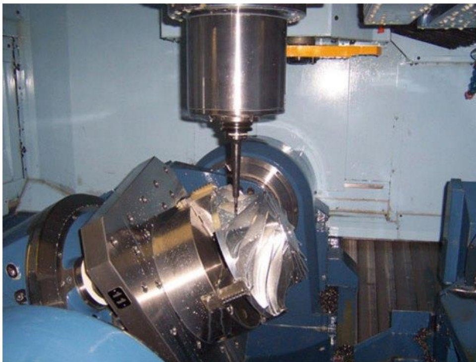
Figura 13 – Fresadora CNC com 5 eixos Fonte: MECÂNICA INDUSTRIAL, 2019
