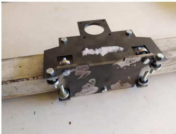
Figura 18 – Pórtico associado com Metalon Fonte: Autoria própria, 2021
