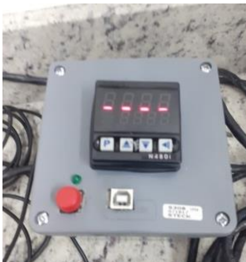
Figura 17 - Adaptações para a fixação do microcontrolador.
