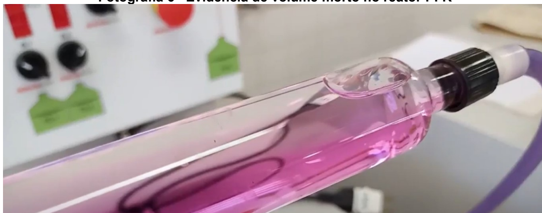
Fotografia 6– Evidência de volume morto no reator PFR
