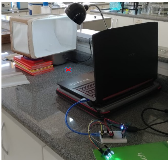
Fotografia 1 – Leitura dos parâmetros RGB pelas técnicas de colorimetria
