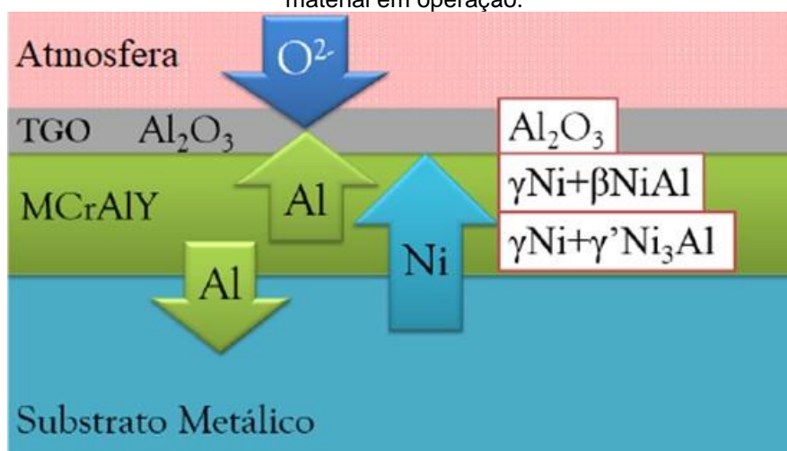
Figura 3 – Esquemática do sentido de difusão dos elementos químicos para formação da TGO com o material em operação.
