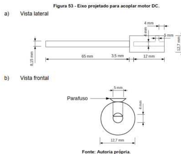
Figura 34 – Eixo para acoplamento do motor DC
