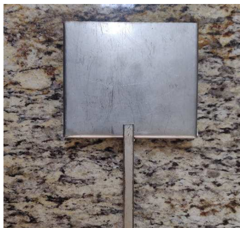
Figura 33 – Material metálico utilizado para testes de distância e reflexão
