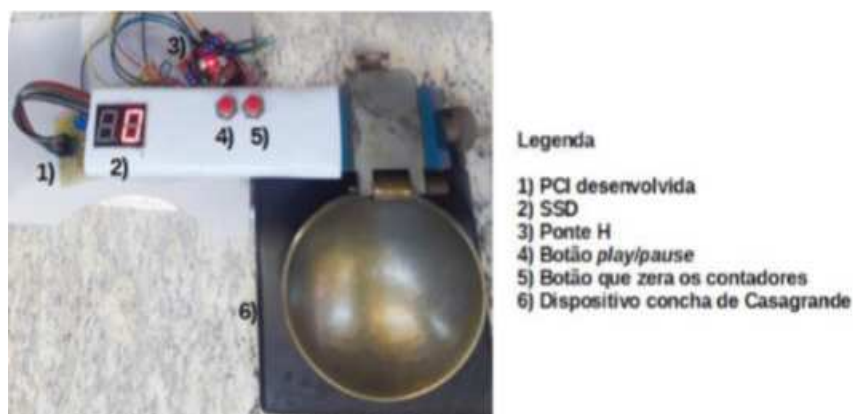
Figura 8 – Concha de Casagrande automatizado
